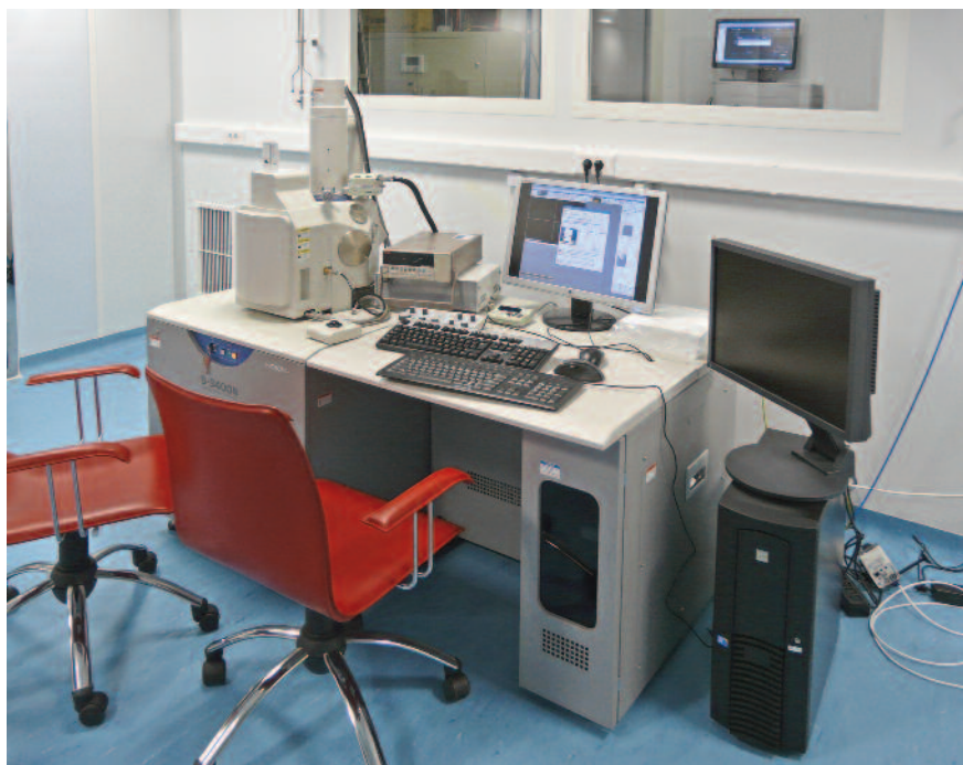
Fig.12. Instalația de nanolitografie cuplată la un microscop electronic de baleiaj, în camera curată de clasa ISO1000
